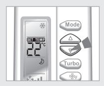
Le mode Good Sleep aide les utilisateurs à bien s'endormir quand ils se couchent qu' ils aient trop chaud pour dormir ou s'ils soient réveillés par le froid. Le mode Good Sleep ne peut être sélectionné que le climatiseur est allumé ou dans le mode de refroidissement/de chauffage.
