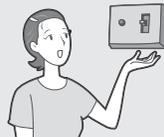
► Installez l'interrupteur et le disjoncteur réservés au climatiseur.
