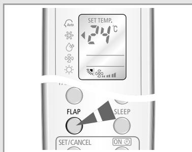
*Selon la hauteur de l'unité intérieure sur le mur de la pièce, vous pouvez régler l'orientation des lames de sortie d'air au bas de l'unité, pour augmenter l'efficacité du climatiseur.*
