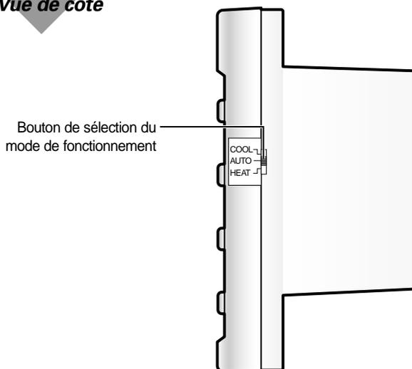
**Note** ♦ Choisissez le mode de fonctionnement approprié entre le mode Cool (réfrigération) / Auto / Heat (chauffage) en utilisant le bouton de sélection du mode de fonctionnement.
