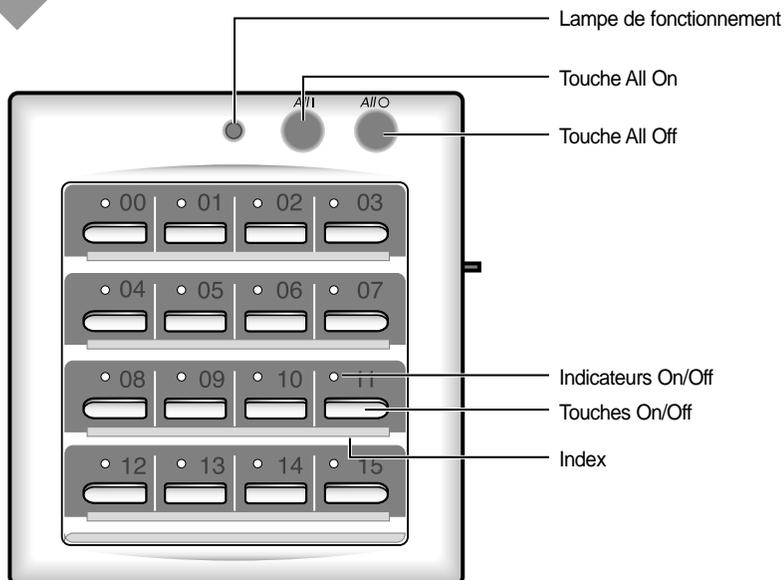
**Note** ♦ La lampe de fonctionnement s'allume même lorsqu'un seul climatiseur relié au contrôleur centralisé est en fonctionnement.
