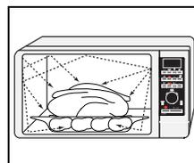
1. Les micro-ondes générées par le magnétron sont réfléchies sur les parois du four et réparties de façon homogène à l'intérieur du four pendant la cuisson grâce à la rotation du plateau sur lequel sont placés les produits. Ce procédé assure donc une cuisson homogène des aliments.
