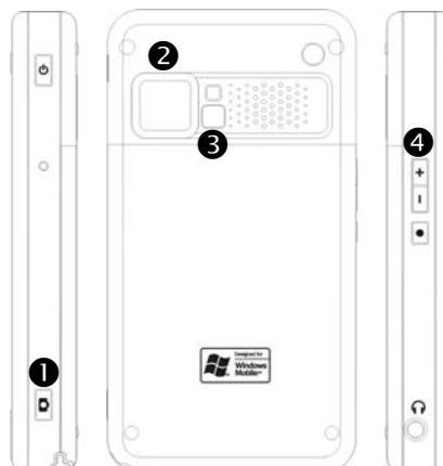
① Déclencheur    ② Objectif    ③ Miroir d'aperçu    ④ Mise au Point
