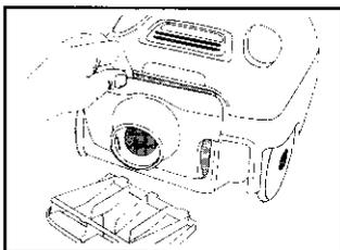
2835, 2838, 2855, 2880: Si le flexible était bloqué, il peut être débouché. Remplacer le volet de filtre par le volet de filtre avec fonction d'évacuation.
