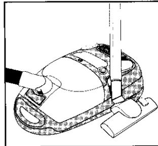
Le tube et le suceur peuvent être montés en position de repos horizontale.
