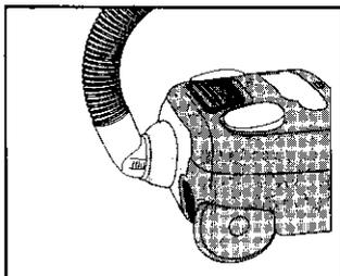
2835, 2838, 2855, 2880: Fixer le clip du flexible sur la sortie du volet du filtre. Mettre le bout de la crosse sur le raccordement flexible à l'avant de l'appareil et mettre en marche l'aspirateur.
