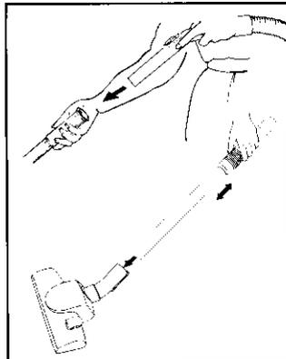
**2820, 2830, 2835, 2838, 2855, 2880:** Raccorder le tube télescopique sur la crosse du flexible et le suceur combiné. Pour le retirer, dévisser et tirer avec précaution.
