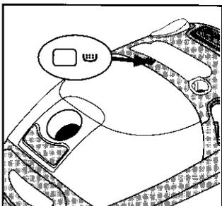
L'indicateur de remplissage de sac signale lorsque l'appareil est obstrué et que sa puissance d'aspiration est si réduite qu'il risque de surchauffer.
