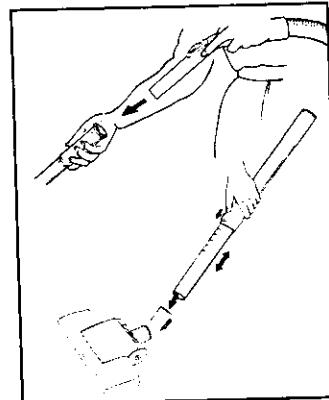
**2830, 2855, 2870:** Raccorder le tube télescopique sur la crosse du flexible et le suceur combiné.
