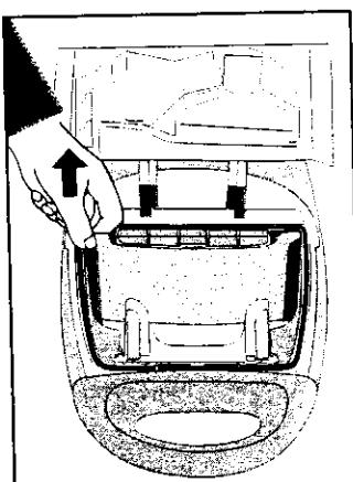
**2810, 2830:** Le microfiltre doit être remplacé tous les cinq sacs à poussière.
