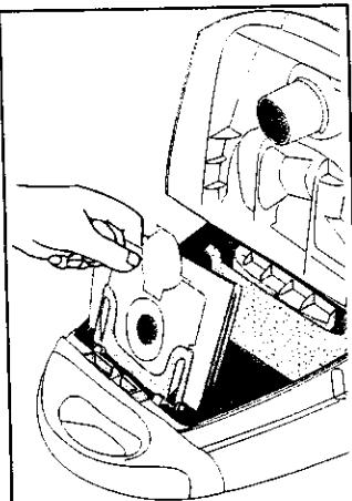
Le filtre de sécurité du compartiment sac doit être remplacé en cas de besoin ou bien deux fois par an environ. Ouvrir le couvercle et extraire la cassette filtre en la tirant vers le haut.
