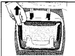
Le filtre de sécurité du compartiment sac doit être remplacé en cas de besoin ou bien deux fois par an environ. Ouvrir le couvercle et extraire la cassette filtre en la tirant vers le haut.
