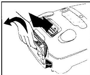
**2815, 2820, 2830:** Le microfiltre doit être remplacé tous les cinq sacs à poussière.
