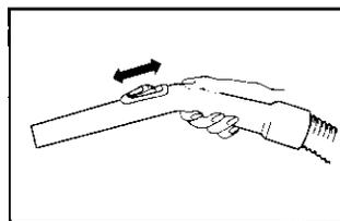
La puissance d'aspiration peut être modulée à l'aide du régulateur située sur la crosse du flexible.
