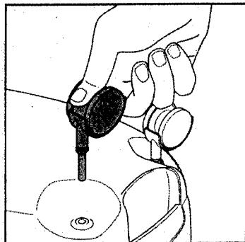
Montera de två medföljande framhjulen (8) på behållarens (7) undersida. Fuktta något på hjulets styrbult så går det lättare att trycka fast hjulet. Kontrollera att styrbullen bottnar i hålet.
