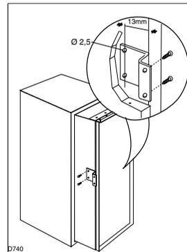
Zorg ervoor dat er een afstand van 44 mm vrij blijft tussen het keukenmeubel en de rand van het apparaat. Het onderste scharnierdeksel, dat in het zakje met accessoires zit, is handig om de exacte positie van het keukenmeubel en het apparaat te bepalen. Zorg er ook voor dat het apparaat het netsnoer niet afklemt.
