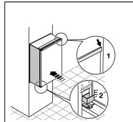
Gerät mit den 4 beiliegenden Schrauben befestigen.
