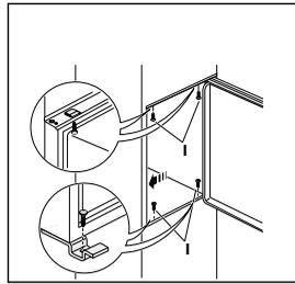
Fugenabdeckprofiloben um die Winkeldicke ausschneiden und zwischen Gerät und Möbelseitenwand eindrücken.
