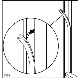
Brechen Sie aus der Plastikabdeckung (E), die das Scharnier mit Stift bedeckt, die in der Abbildung gekennzeichneten Teile heraus.
