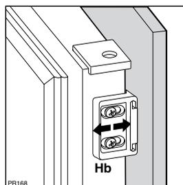
**Vergewissern Sie sich nach Ausführung des Anschlagwechsels der Türen, daß alle Schrauben fest angezogen sind und überprüfen Sie auch, ob die Magnetdichtung am Möbel perfekt anliegt. Bei einer niedrigen Raumtemperatur (z.B. im Winter) kann es vorkommen, dass die Dichtung nicht perfekt am Schrank haftet. Die Wiederherstellung der Dichtung erfolgt automatisch nach gewisser Zeit. Wollen Sie aber diesen Prozess beschleunigen, so genügt es die Dichtung mit einem Fön zu erwärmen.**
