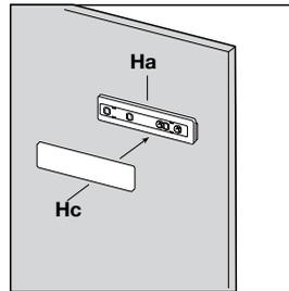
De deur van het apparaat en die van de kast met een hoek van ongeveer 90° openen. IJzer (B) in geleider (A) aanbrengen. De deuren samen vasthouden en de gaten aangeven zoals in de tekening. De ijzers weghalen en gaten van Ø2 mm. boren op een afstand van 8 mm. van de buitenrand van de deur.
