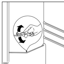
In het vriesvak dient u echter de rijp te verwijderen, wanneer deze een laag van circa 4 mm vormt. Gebruik hiervoor een kunststof spatel. Voor het uitvoeren van deze handeling hoeft u het apparaat niet uit te schakelen of het vriesvak leeg te maken. Wanneer zich een dikke laag ijs gevormd heeft, dient u het gehele apparaat te ontdooiden.
