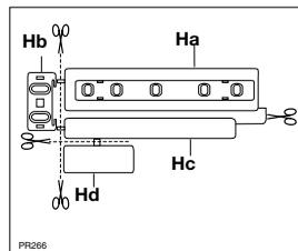
Die Schiene (Ha) auf der Innenseite der Möbeltür auflegen (siehe Abb.) und die Position der äußeren Bohrlöcher anzeichnen. Nachdem die Löcher gebohrt wurden, die Schiene mit den mitgelieferten Schrauben befestigen.
