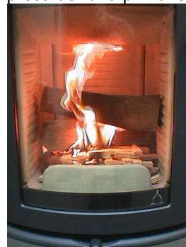
III. 3 : Chiusura presa dell'aria primaria
