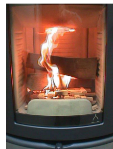
III.4 : Chiusura presa d'aria primaria
