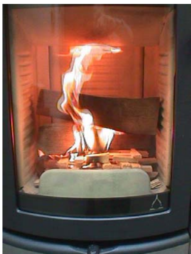
Fig. 5 : Fermeture du coulisseau d'entrée d'air primaire
