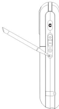
⚙️ **Démarrage à froid:** Pressez et maintenez enfoncé la “Touche Alimentation” d’une main et utilisez la pointe du stylet pour presser la Touche “Réinitialiser” de l’autre main. Relâchez simultanément la “Touche Alimentation” et la Touche “Réinitialiser”.
