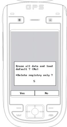
2. Supprimer registre seulement? (La donnée par défaut est "Non" (No). En cas d'absence de sélection de l'option Oui ou Non, le système exécutera automatiquement l'élément par défaut après quelques secondes.)
