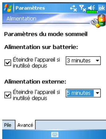
3. Tapoter sur
