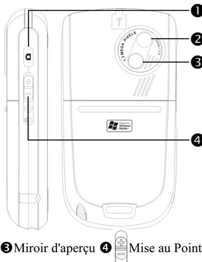
① Déclencheur ② Objectif ③ Miroir d'aperçu ④ Mise au Point
