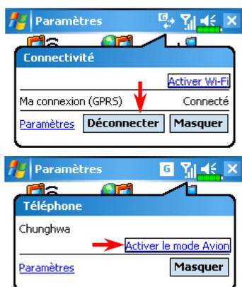
1. Déconnecter le GPRS: Tapotez sur
