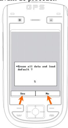
1. Effacer toutes les données et charger la donnée par défaut? (La donnée par défaut est "Non" (No). En cas d'absence de sélection de l'option Oui ou Non, le système exécutera automatiquement l'élément par défaut après quelques secondes.)
