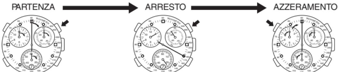
Dopo aver misurato 3 minuti con il cronografo, la lancetta 1/50 di secondo si ferma sulla posizione 0, ma il cronografo continua a misurare il trascorrere del tempo. Il tempo esatto viene indicato al momento dell'arresto del cronografo, premendo il bottone A.
