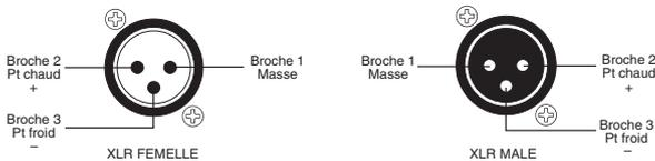
Pour câbler les sorties du DigiPage en asymétrique, la broche 2 doit servir au point chaud et la broche 1 à la masse. La broche 3 doit être laissée libre et NON reliée à la broche 1.
