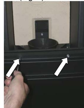
Fig. 4 : Desserrage des deux vis de l'ouverture de révision
