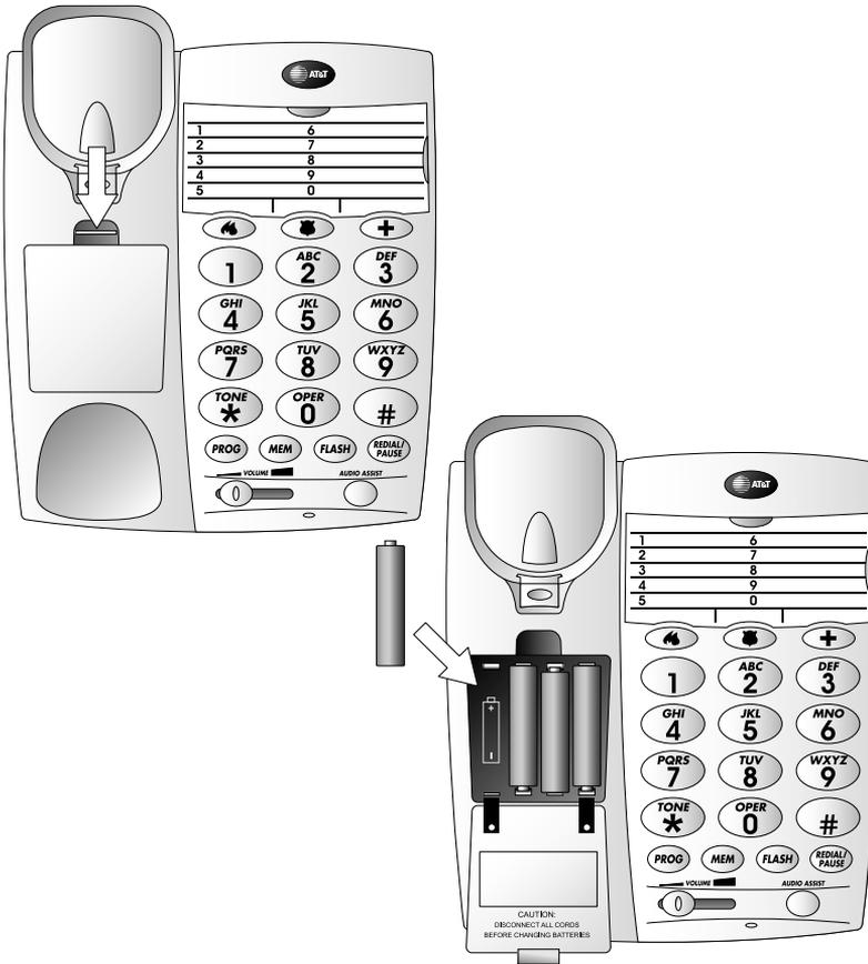
**REMARQUE :** Les piles sont nécessaires afin que le rétroéclairage du clavier s'allume. Si le rétroéclairage du clavier est faible lorsque l'éclairage ambiant est restreint ou s'il n'y a aucun rétroéclairage, ceci signifie que les piles sont faibles et qu'elles doivent être remplacées. Remplacez les piles par quatre piles "AA" pleinement chargées.
