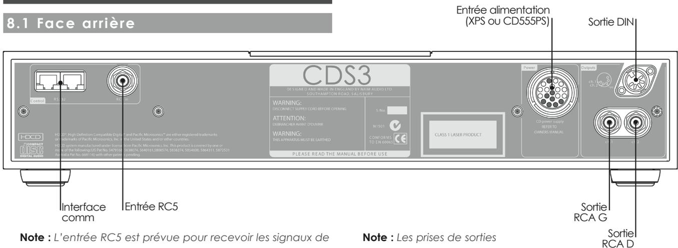
**Note :** L'entrée RC5 est prévue pour recevoir les signaux de commande externes pour les installations multi-pièces. Pour de plus amples renseignements, veuillez contacter votre revendeur ou directement Naim Audio. La prise optionnelle d'interface RJ45 comm. permet de commander le lecteur à distance dans les installations personnalisées. Pour de plus amples renseignements, veuillez contacter votre revendeur ou directement Naim Audio.
