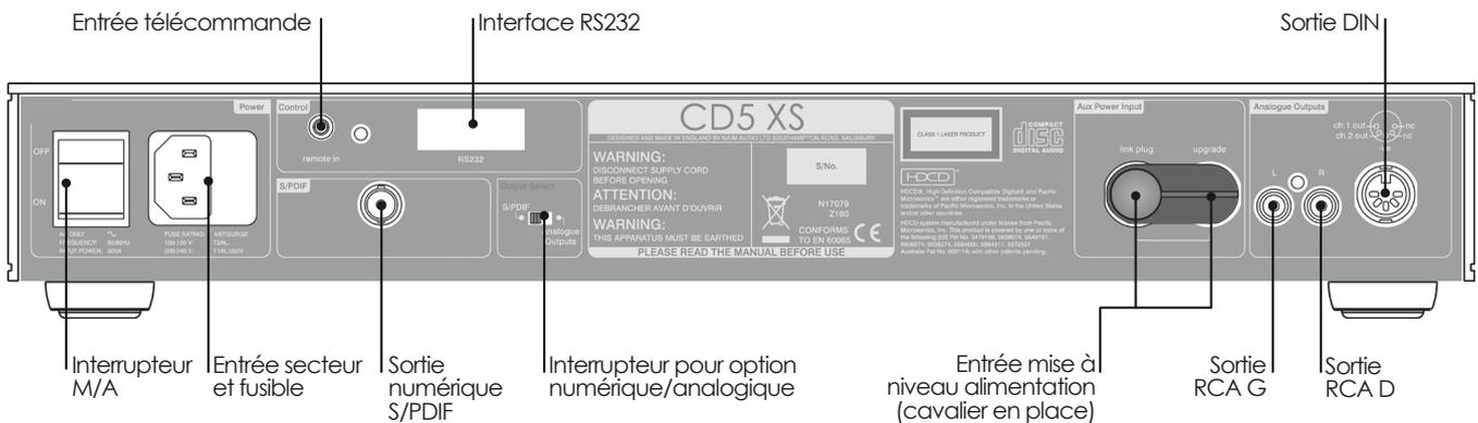
**Note :** Les prises de sorties RCA et DIN ne doivent pas être connectées en même temps.
