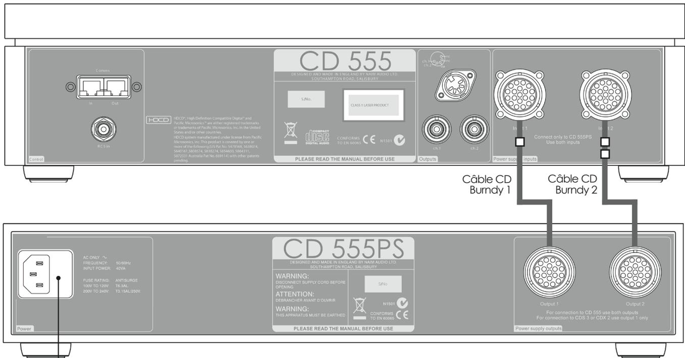
**Note :** Pour relier le CD555 au CD555PS, il faut deux câbles Burndy différents. Le câble 1, qui est marqué d'une seule bande d'identification sur sa gaine d'orientation, relie les prises femelles 1, et le câble 2, qui est marqué de deux bandes d'identification sur sa gaine d'orientation, relie les prises femelles 2.
