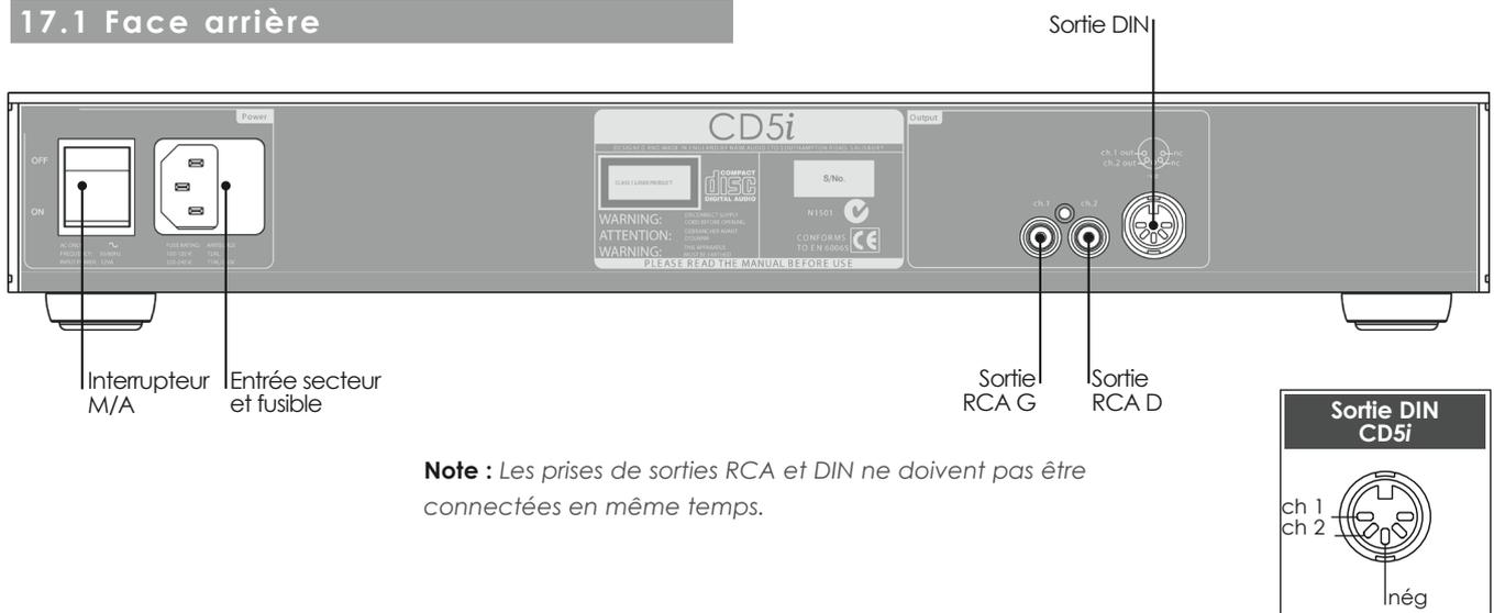
**Note :** Les prises de sorties RCA et DIN ne doivent pas être connectées en même temps.
