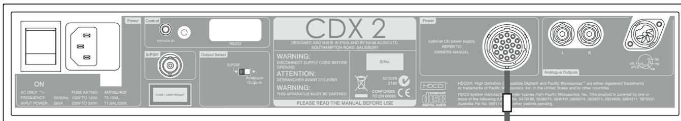
**Note :** En cas d'utilisation d'une alimentation CD 555PS avec un lecteur CDX2, utiliser uniquement la prise de sortie alimentation N° 1.
