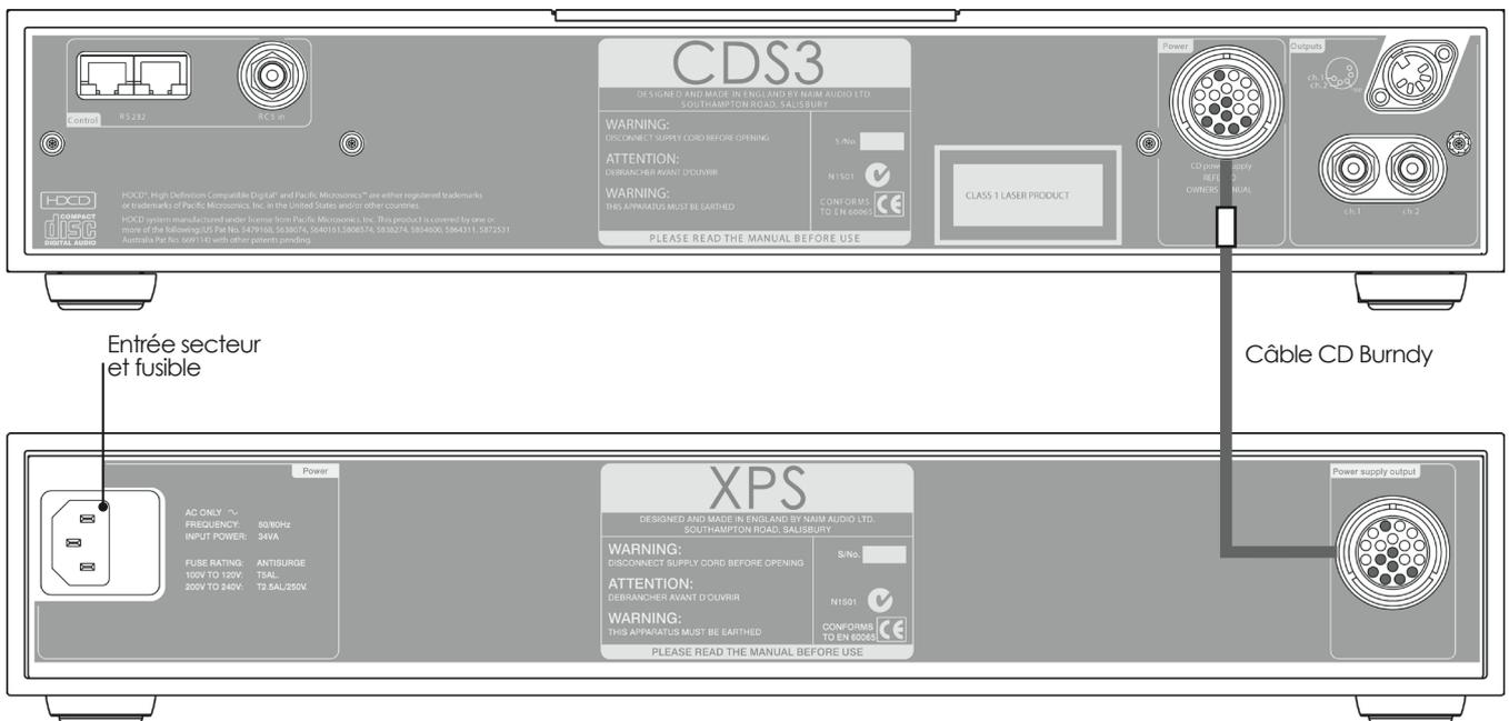
**Note :** En cas d'utilisation d'une alimentation CD 555PS avec un lecteur CDS3, utiliser uniquement la prise de sortie alimentation N° 1.
