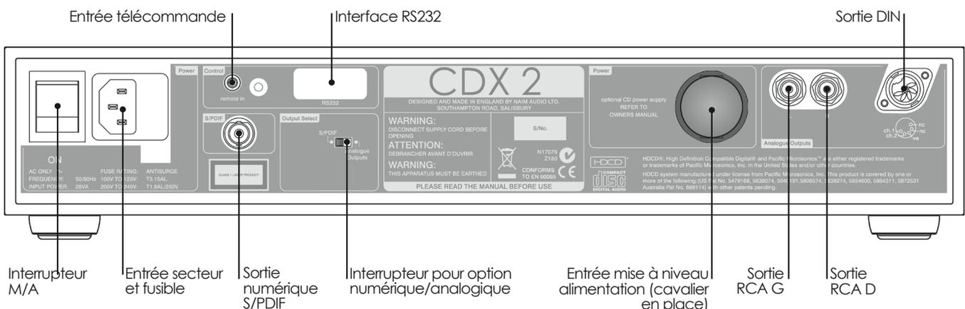
**Note :** Les prises de sorties RCA et DIN ne doivent pas être connectées en même temps.
