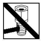
Do not insert insulated section of speaker wire. No inserte la sección aislada del cable altavoz. N'insérez pas la partie isolé du fil. Keinen isolierten lautsprecher-
