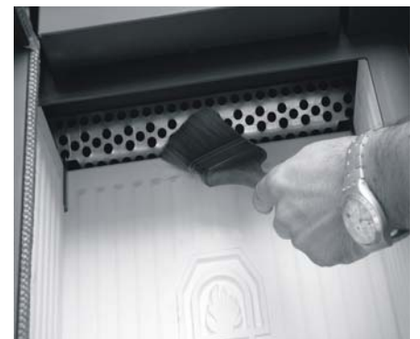
Fig. 4 – Nettoyage du deflecteur
