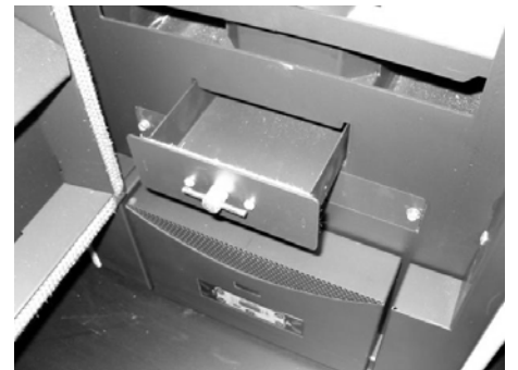
Fig. 3 – Nettoyage du compartiment de dépôt des cendres
