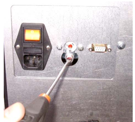
Fig. 25 - Comment réarmer le thermostat à boule une fois que la poêle est froide.
