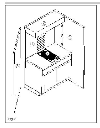
Les distances minimales à respecter entre la surface de cuisson et la surface horizontale située au-dessus du plan de cuisson doivent être :
