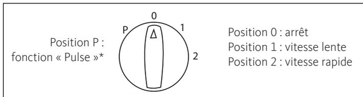
\*La fonction « **Pulse** » permet de mixer par impulsion pour contrôler le degré de résultat d'une préparation jusqu'au degré de finesse désiré. Vous devez maintenir la main sur la touche pour qu'elle fonctionne. Dès que vous relâchez la touche, l'appareil s'arrête. Travaillez par impulsion de 10 secondes. **Maintenez le couvercle d'une main lors de cette opération.**
