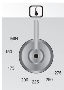
Ouvrez complètement la porte du four et tournez la manette du thermostat en sens inverse horaire jusqu'à la température maximale ; l'allumeur électrique à étincelle s'active automatiquement. Après l'allumage, maintenez la manette enfoncée pendant quelques secondes pour permettre au thermocouple de chauffer.
