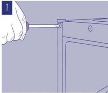
1 Retirer les caches-vis positionnées à l'extérieur de l'appareil.
