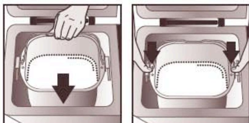
Introduisez la cuve. Appuyez sur la cuve pour l'enclencher sur l'entraîneur et de manière à ce qu'elle soit bien clipsée des 2 côtés.
