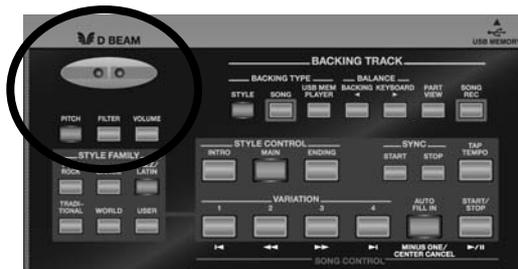
1. Appuyez sur un des boutons [PITCH], [FILTER] ou [VOLUME] de la section D BEAM section (son témoin s'allume en bleu).
