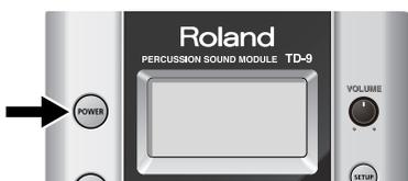
\* Le TD-9 est doté d'un circuit de protection: un délai de quelques secondes s'écoule donc lors de la mise sous tension avant que le produit ne fonctionne normalement.
