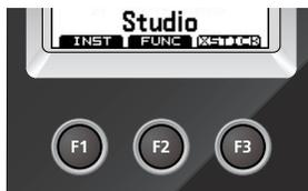
Les boutons [F1]~[F3] sont des "boutons de fonction". La ligne inférieure de l'écran affiche les fonctions des boutons [F1]~[F3]. Dans ce manuel, "[KIT]-[F2] (FUNC)" signifie qu'il faut appuyer sur le bouton [KIT] puis sur le bouton [F2] (dans cet exemple, l'indication "FUNC" apparaît au-dessus du bouton [F2]).
