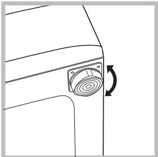
2. Als de vloer niet volledig horizontaal is kunt u de onregelmatigheid opheffen door de stelvoetjes aan de voorkant losser vast te schroeven (zie afbeelding); de inclinatiehoek, gemeten ten opzichte van het werkvlak, mag de 2° niet overschrijden.
