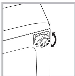
2. Sollte der Boden nicht perfekt eben sein, müssen die Unebenheiten durch An- bzw. Ausdrehen der vorderen Stellfüße ausgeglichen werden (siehe Abbildung), der auf der Arbeitsfläche zu ermittelnde Neigungswinkel darf 2° nicht überschreiten.
