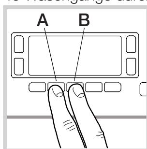
Um das Programm zu aktivieren, drücken Sie fünf Sekunden lang gleichzeitig die Tasten **A** und **B** (siehe Abb.).
