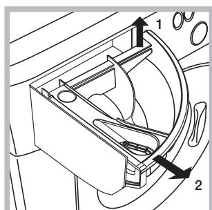
Heben Sie die Schublade leicht an und ziehen Sie sie nach vorne hin heraus (siehe Abbildung).
