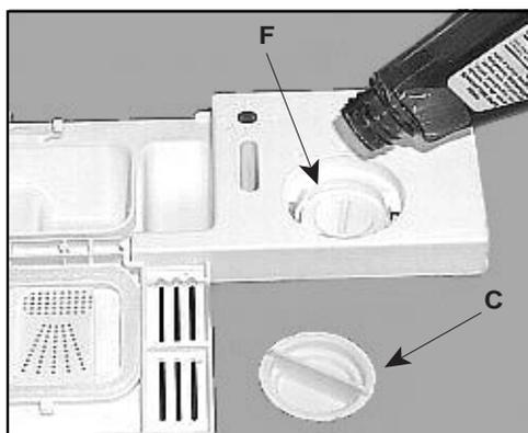
La regolazione della quantità di brillantante usato migliora l'asciugatura. Se sulle stoviglie noti gocce d'acqua o macchie, ruota il regolatore verso i numeri più alti. Se invece le tue stoviglie presentano delle striature bianche, ruota il regolatore verso i numeri più bassi.
