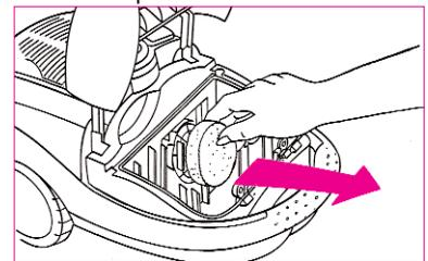
**Nettoyez le filtre mousse de sortie d'air (selon modèle).**
