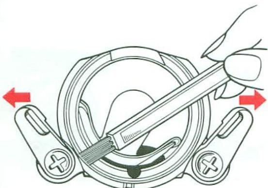
Quand le fil ou des morceaux de fil se sont incrustés entre la navette et la loge de celle-ci, le résultat sera que la machine fonctionnera soudainement plus vite ou se bloquera brusquement.
