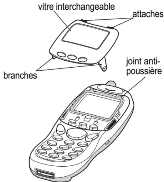
Le joint anti-poussière amovible doit être manié avec précaution. Il est positionné sur la partie supérieure du téléphone autour de l'écran et protège votre téléphone des infiltrations de poussière.
