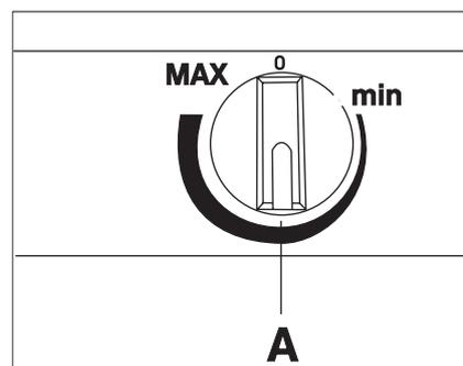
**NOTA: Après chargement de l'appareil de denrées fraîches ou après ouvertures répétées (ou ouverture prolongée) de la porte il est normal que l'inscription «OK» n'apparaisse pas dans l'indicateur de température; attendez au moins 12h avant de réajuster le thermostat.**
