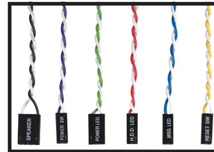
Câbles des interrupteurs et LED
