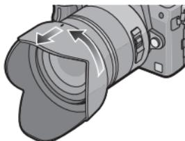
2 Drehen Sie die Gegenlichtblende um und setzen Sie sie wie oben beschrieben wieder auf.
