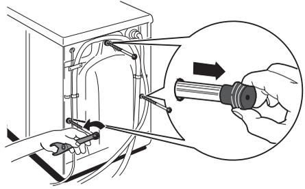
4. Bouchez les trous à l'aide des caches plastique fournis avec l'appareil (dans le sachet en plastique contenant la notice d'utilisation, placé dans le tambour).
