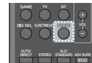
Appuyez sur la touche **PHASE** pour activer ou désactiver la fonction **P.CTL (Phase Control / Contrôle de phase)**.
