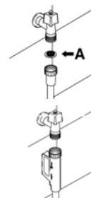
Il est possible d'alimenter le lave-vaisselle avec de l'eau **ne dépassant pas 60°C**. En alimentant l'appareil avec de l'eau chaude, le temps de lavage sera abrégé de 20 minutes environ, mais son efficacité sera toutefois légèrement réduite. Le raccordement devra être effectué à la prise domestique d'eau chaude et selon les mêmes modalités décrites pour le raccordement à la prise d'eau froide.
