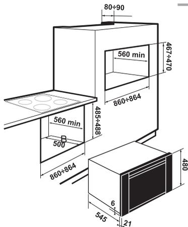
La fixation s'effectue à l'aide de 4 vis placées aux angles « C » du cadre de la porte du four après avoir démonté les panneaux latéraux fixés par les vis « A » et les supports « B », tel que l'indique la figure 3. Pour remonter les panneaux latéraux, assurez-vous de bien avoir encastré les chevilles positionnées à l'intérieur de ces derniers à l'aide des supports « B », puis revisser les vis « A ».
