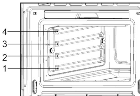
La plaque perforée contenant les aliments sera introduite de préférence au niveau 2. Dans ce cas, il est important que la plaque non perforée soit introduite au niveau 1. De cette façon, les liquides ou les jus qui s'écouleraient, seront recueillis et l'appareil restera propre.
