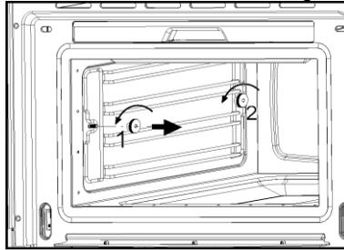
2. Dévisser et enlever les écrous moletés 2 se situant à l'arrière des côtés des guides à plateaux dans le sens inverse des aiguilles d'une montre. Ne pas retirer entièrement ces écrous-là.
