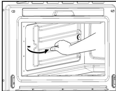
3. Exercer une pression sur les guides à plateaux vers la paroi intérieure de la cavité, puis les faire glisser vers l'avant de l'appareil.
