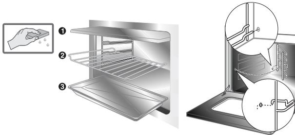
Pour nettoyer le fond du four, exécuter les opérations suivantes à **four froid**.
