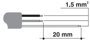
L'extrémité à brancher à l'appareil devra avoir le fil de mise à terre (jaune-vert) plus long d'au moins 20 mm.
