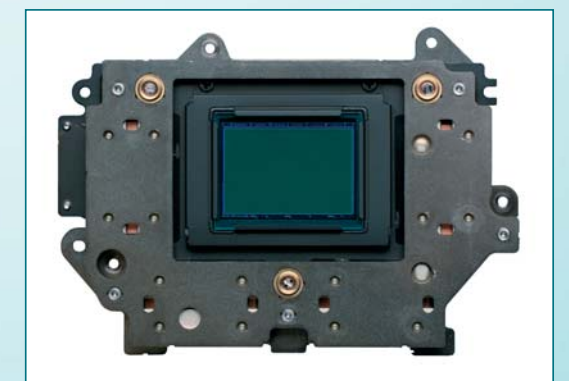
Le capteur CCD est scellé à un cadre métallique pourvu d'aimants permanents.
