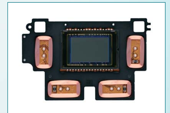
Le capteur CCD et les électroaimants du système de stabilisation
