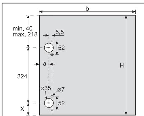
si la largeur (**b**) est plus importante, la cote **a** doit être augmentée
