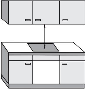
La distance de sécurité entre la hotte et la table de cuisson prescrite par le fabricant de la hotte doit être respectée. Si vous ne disposez pas d'indications du fabricant à ce sujet ou si des matériaux inflammables sont montés (portique par exemple) au-dessus de la table de cuisson, la distance de sécurité doit être d'environ 760 mm min.
