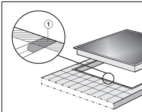
Les joints ① et la zone hachurée sous le cadre de la table de cuisson doivent être lisses et égaux afin que le cadre repose bien sur les bords et que le joint d'étanchéité situé sous le rebord de la partie supérieure de la plaque puisse assurer une étanchéité suffisante avec le plan de travail.
