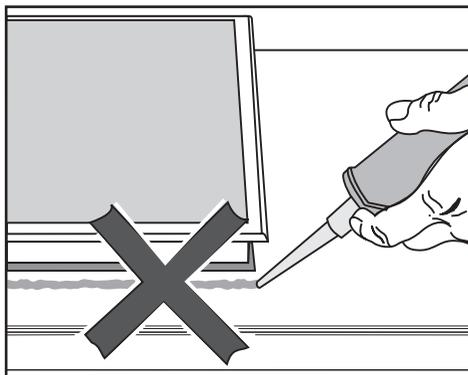
N'utilisez pas de pâte à joint à moins que cela vous soit spécifié. La bande sous le pourtour de la partie supérieure de la table de cuisson garantit une étanchéité suffisante par rapport au plan de travail.
