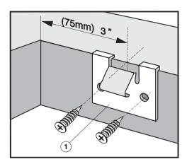
■ Placez les pinces à ressort fournies ① aux endroits marqués selon les indications ci-dessus : posez-les sur le rebord supérieur de la pièce découpée et fixez-les ensuite à l'aide des vis 3,5 x 25 mm jointes.
