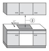
② En règle générale, une distance sécuritaire de 30 po minimum (760 mm) doit être respectée, entre l'appareil et tout objet inflammable placé au-dessus, c.-à-d. armoires, hotte ou rangement à ustensiles. Si le fabricant de ces articles préconise une autre distance, celle-ci doit être respectée. Ces distances sont indiquées dans le mode d'emploi et les instructions d'installations respectifs.
