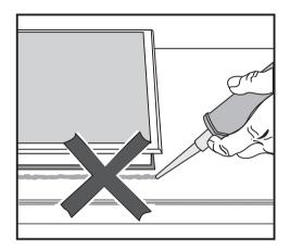
La plaque de cuisson ne doit pas êtrescellée de façon permanente au comptoir lors de l'installation.
