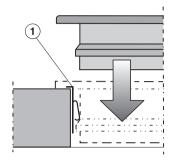
Pour les comptoirs en granit, les pinces à ressort ① doivent être positionnées et fixées à l'aide d'un ruban adhésif robuste à double face.
