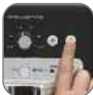
Appuyez par impulsion sur la touche ☕ le nombre de fois nécessaire pour sélectionner le niveau de la dureté de l'eau utilisée.
