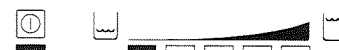
Réservoir vide : clignotement du voyant + bip sonore et arrêt de la génération de vapeur.
