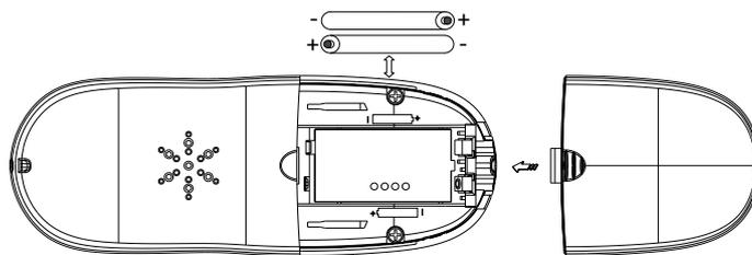
insertion des batteries      fermeture de la trappe
